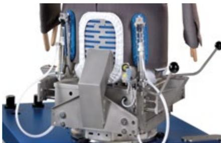
Pneumatische Seitenschlitz-Klemmen können zum problemlosen und abdruckfreien Finishen von Sakkos mit Seitenschlitzen zugeschaltet werden.
