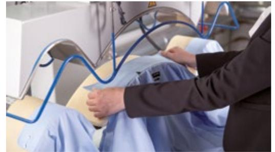
Die integrierte Absaugung in den unteren Pressköpfen sorgt für eine sichere Positionierung und schnelle Abkühlung nach dem Pressvorgang der Manschetten und des Kragens.
