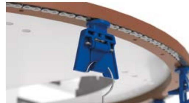
Das Conveyor-System arbeitet mit einem wartungsfreien Kettensystem. Die Transportkette wird in Gleitführungen und sanften Radien statt über Kettenräder geführt. Dadurch funktioniert das Kettensystem nahezu verschleißfrei.
