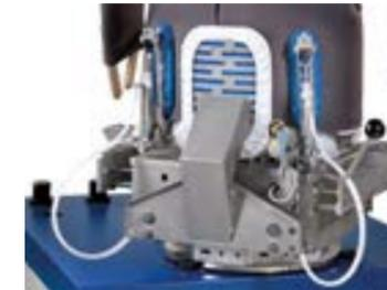
**Pneumatische Seitenschlitz-Klemmen** können zum problemlosen und abdruckfreien Finishen von Sakkos mit Seitenschlitzern zugeschaltet werden.
