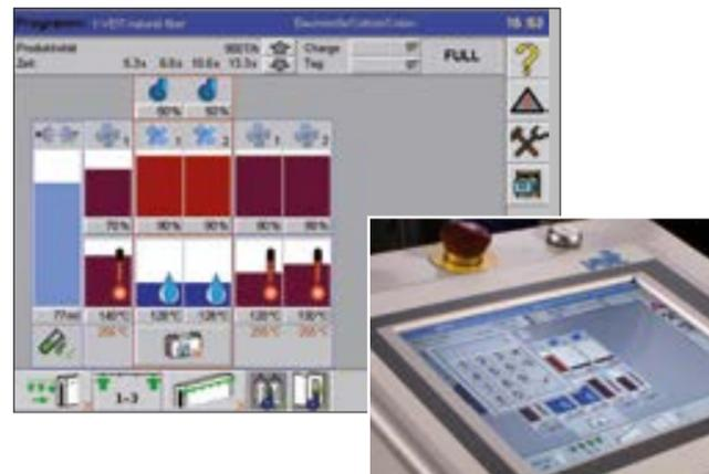
Die Steuerungen der verschiedenen Module sind über eine BUS-Leitung mit der Bedieneinheit verbunden. Ihre benutzerfreundliche Oberfläche ermöglicht den schnellen Zugriff auf alle wichtigen Funktionen und Einstellparameter der einzelnen Module. Darüber hinaus können Programme abgespeichert und bei Bedarf aufgerufen werden.
