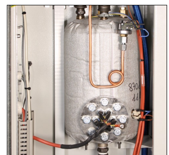
DER EINGebaUTE DAMPFERZEUGER Für Leistung auf engstem Raum der Hosentopper 8741 mit einem 9kW Dampferzeuger.
