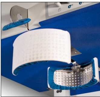
LÄNGSBUNDSPANNER für Hosentopper VEIT 8741
