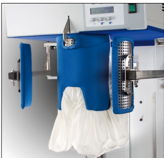
BUNDFALTENKLAPPEN Durch die optionalen Bundfaltenklappen werden die oberen Bundfalten pneumatisch fixiert und angepresst. Dies spart Zeit und Kosten und sorgt für eine kurze Amortisation.
